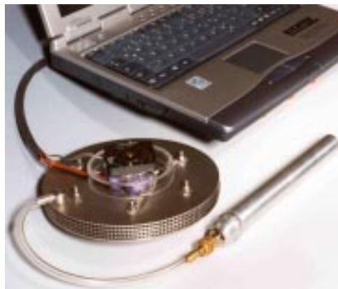
Abbildung 6a: Miniatur-Brennstoffzelle des Fraunhofer ISE mit integriertem DC/DC-Wandler und mit Hydridspeicher
